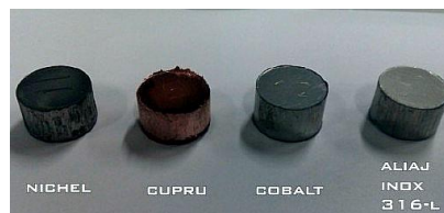
Figura 23. Probele presate pregătite pentru sinterizare.
