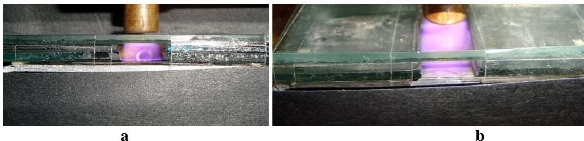
Figura 2 Descărcare cu barieră dielectrică generată cu instalația “PLAS-01”: a – vedere din față, b – vedere de ansamblu.
